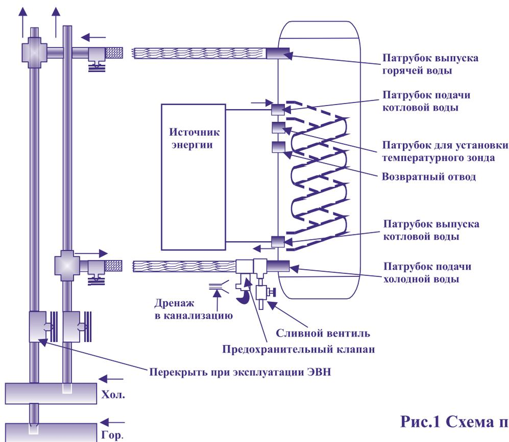
Рис.1 Схема подключения
